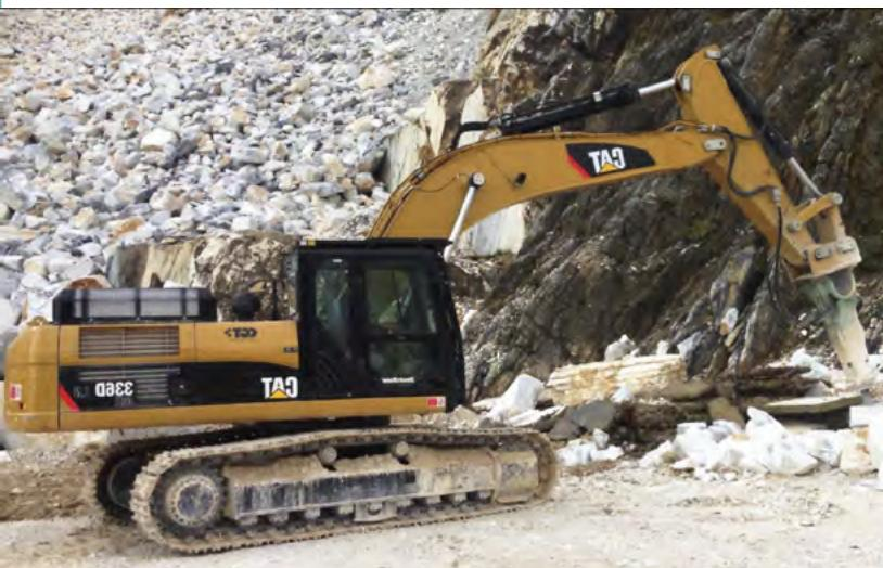
Frantumazione scaglie con escavatore meccanico e martello idraulico
